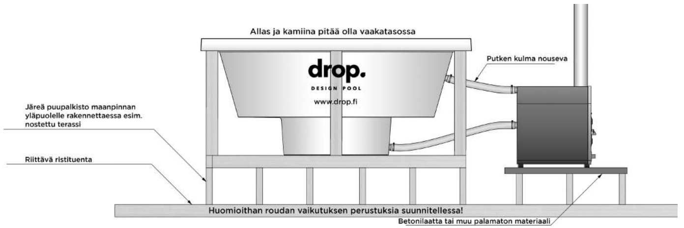
Altaan asennus puurakennelmalle
